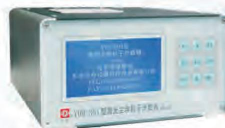
Y09-301AC-DC型 (交直流两用) 激光尘埃粒子计数器用于测量洁净环境单位体积空气内的尘埃粒子大小及数目, 可直接检测洁净度等级为三十万级至百级的洁净环境。仪器采用了半导体激光光源, 液晶屏大屏幕显示, 体积小、重量轻、检测精度高、功能操作简便明了, 微处理器控制, 可贮存、打印测量结果, 测试洁净环境十分便利。另外, 可通过计算机专用团建下载存储数据。产品广泛应用于电子、光学、化学、食品、化妆品、医药卫生、生物制品、航空航天等部门。
