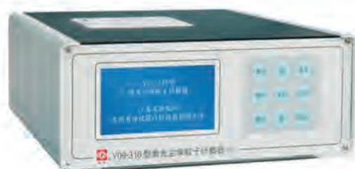
Y09-310 (LCD或AC-DC) 大流量激光尘埃粒子计数器用于测量洁净环境中单位体积空气内的尘埃粒子大小及数目, Y09-310可直接检测洁净度等级为三十万级至百级的洁净环境。Y09-310采用半导体激光光源、大屏幕液晶显示、微处理器控制, 检测精度高, 功能键设计简洁, 易于操作, 测量数据可储存及打印, 十分适于洁净环境的检测。另外, 可通过专用通讯软件将尘埃粒子计数器采集的数据上传至电脑中, 并可在office的excel中编辑、保存和打印。Y09-310大流量激光尘埃粒子计数器广泛应用于电子、光学、化学、食品、化妆品、医药卫生、生物制品、航空航天等部门。
