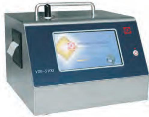
Y09-5100型激光尘埃粒子计数器用于测量空气环境中单位体积空气内的尘埃粒子大小及数目，可直接检测洁净等级为三十万级至百级的洁净环境，其是为了适应国家新政策和新导向而开发的新一代产品。本仪器采用半导体激光光源，大触摸屏显示，体积小，重量轻，检测精度高、流量大、采样时间短、功能操作简单明了，无需计算机数据采集，可直接保存于U盘等存储介质，亦可电脑控制，可贮存、打印采样结果，内置热敏微型打印机，测试环境十分便利。广泛应用于电子、光学、化学、食品、化妆品、医药卫生、生物制品、航空航天等部门。
