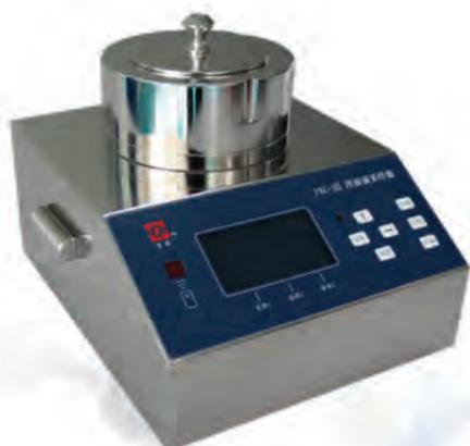
FKC-III型浮游细菌采样器是一种高效的多孔吸入式微生物采集器。该设备根据等速采样理论设计,采样直接,采集头入口风速与洁净室内风速保持基本一致,准确反映洁净室内微生物的浓度。采样时,带尘菌空气高速通过微孔,均匀撞击在培养皿内的琼脂表面;极大提高了活性粒子采集效率,符合ISO14689-1标准。系统设计优化了撞击速度,保证了生物学效率。仪器采用电脑板控制,低噪音采样泵,因此操作简单、性能稳定。采集头采用316L不锈钢制造,适合各种消毒方式。
