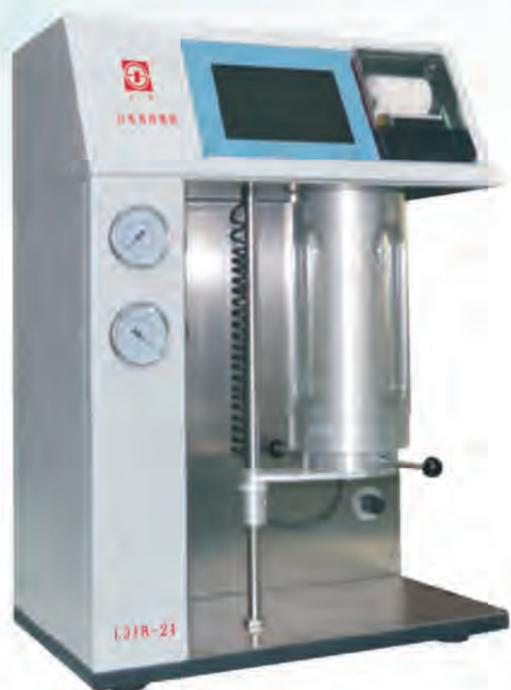
油液颗粒计数器是江苏苏净集团在激光尘埃粒子计数器的基础上，新研制的一款高性能油液颗粒计数器，符合GB/T 18854-2002 (ISO11171-1999)等国家及国际标准相关规定，采用高压泵后，其压力最高可达1MPa，最大粘度可达1500cSt。
