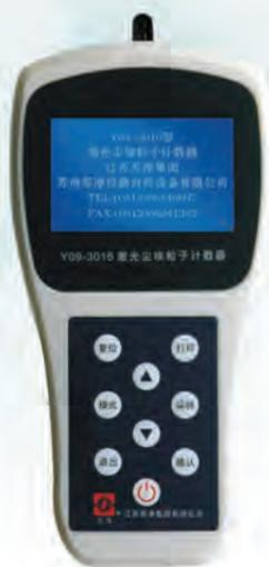
Y09-3016型激光尘埃粒子计数器用于测量洁净环境中单位体积空气内的尘埃粒子大小及数目，可直接检测洁净度等级为三十万级至百级的洁净环境。本仪器采用半导体激光光源，液晶屏显示，微处理器控制，体积小、重量轻、检测精度高、功能操作简单明了，可储存、打印采样结果，测试洁净环境十分便利。广泛应用于电子、光学、化学、食品、化妆品、医药卫生、生物制品、航空航天等部门。
