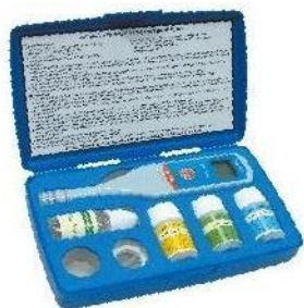
仪器盒：内置校准溶液和备用电池
