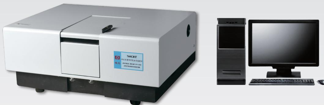
760CRT 双光束紫外可见分光光度计是软件基于Windows 7平台的自动记录分光光度计，界面友好、美观，操作简单，通过打印机可打印出图文合一的分析报告，并将图谱数据或测试数据传送Excel进行处理，可将图谱贴至Word中发表。仪器具有波长扫描、时间扫描、定量分析、定波长测试、多波长测试等功能，适用于医药、药学、生物化学、环境保护、化学工业等实验室的日常分析和研究工作的需要。
