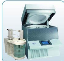
冷凝吸收单元 洗涤器
