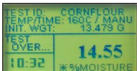
液晶显示屏，显示丰富测定信息
