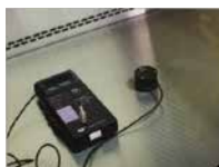
紫外灯照度检测
