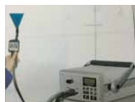
过滤器完成性检测
