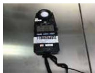
照明灯照度检测
