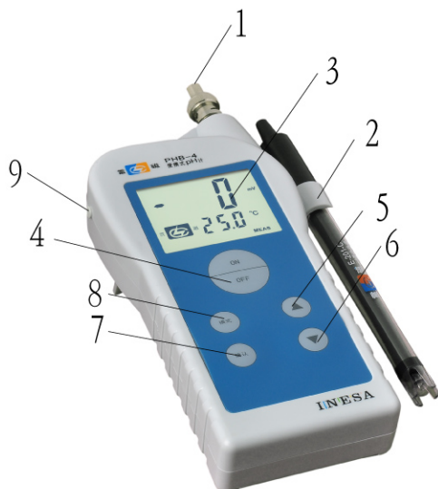
PHB-4 型 pH 计的前面板图(图 1)
