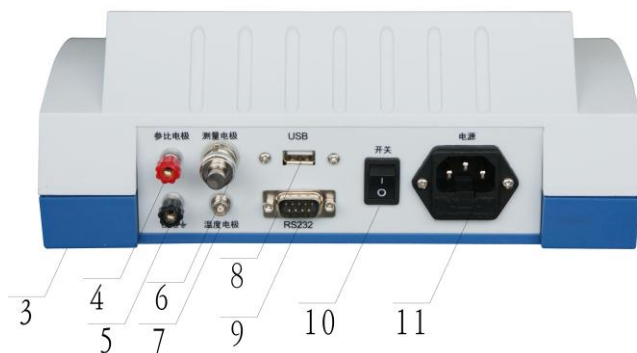
PHSJ-5 型 pH 计的后视图 (图 7)
